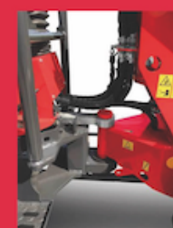
Centralny przegub o solidnej bezobsługowej konstrukcji we wszystkich modelach.
