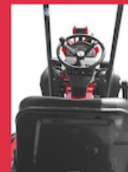
Centralnie umieszczone stanowisko operatora zapewniające maksymalną panoramiczną widoczność wokół maszyny.
